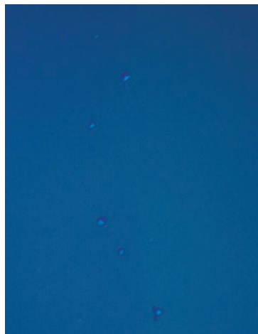
Pinholes (gaatjes) zijn gemakkelijk te identificeren onder UV-lichtinspectie. Geen zaklamp verblinding.
