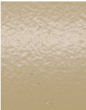
Pinholes (gaatjes) zijn moeilijk te zien bij inspectie van wit licht.
