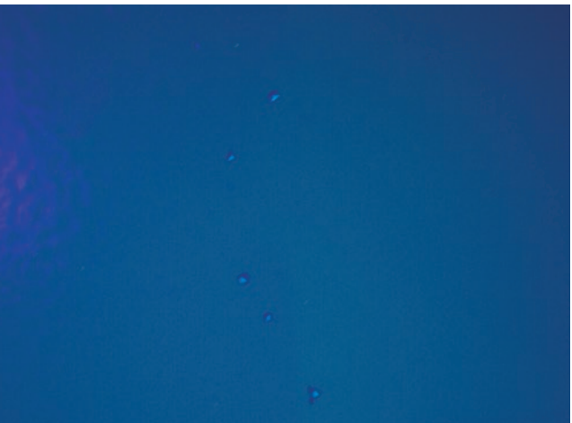
Les trous d'épingle sont faciles à identifier lors d'une inspection à la lumière UV. Pas d'éblouissement de la lampe de poche.
