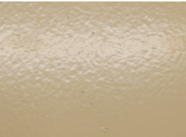
Les trous d'épingle sont difficiles à repérer à la lumière blanche.
