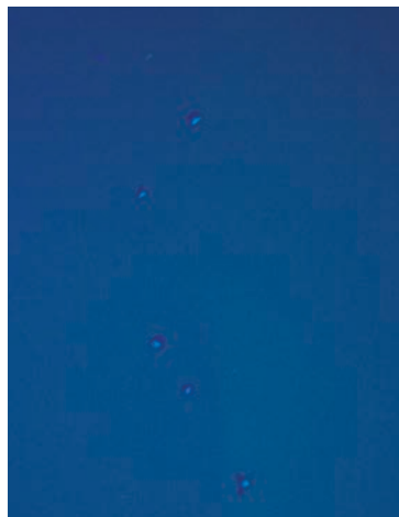
Los poros son fáciles de localizar en una inspección con luz ultravioleta. Se evita el brillo de la linterna.
