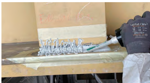
Application facile de Repacor SW-1000 sur un cordon de soudure grâce à sa cartouche pratique.
