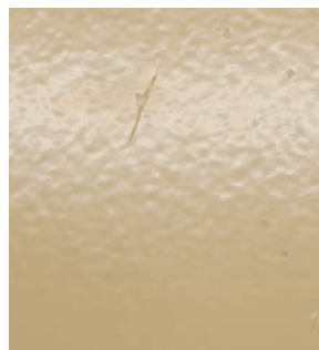
Los poros son difíciles de localizar en una inspección con luz blanca.
